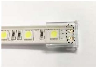
②ケーブルコネクタを準備し針 (pin) をケースに開いた小窓の直下にあるパッドに合わせる
